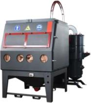
Необитаемые камеры напорного типа КСО®-150-Н-СФ-Р изготовлены из стали толщиной 3 мм и защищены резиновым покрытием от рикошета абразивного материала. Обработка деталей происходит напорным способом при помощи абраzивоструйного сопла. Камеры могут комплектоваться по желанию заказчика стационарным или выдвижным поворотным столом, предкамерами для обработки длинномерных изделий.
