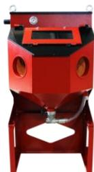
Пескоструйная камера изготовлена из листового металла толщиной 3мм и внутри футерована резиной. Камерные неопреновые перчатки защищают руки оператора и удобны в использовании. Камера по желанию заказчика может иметь фронтальную либо боковую загрузку, оснащена поворотным выдвигаемым или стационарным столом. Инжекторный пистолет комплектуется абразивоструйным соплом различных диаметров, внутри камеры дополнительно находится пистолет со сжатым воздухом для обдува очищенной детали от пыли.
