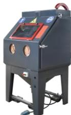
Камеры Струйной Очистки (КСО) разработаны и производится нашим предприятием. Различные габариты позволяют заказчику подобрать пескоструйную камеру в зависимости от поставленных задач. Камеры делятся по типу на инжекторные и напорные.
