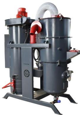
Системы сепарации в комплекте с фильтром применяются для очистки абразивного материала и удаления запыленного воздуха из рабочей зоны пескоструйных камер. После очистки воздух выбрасывается в наружное пространство, а очищенный абразив сыпается в специальную ёмкость, далее автоматически попадает в камеру для повторного использования.
