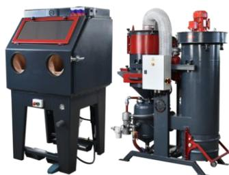
Камеры напорного типа изготовлены из стали толщиной 3мм и защищены резиновым покрытием от рикошета абразивного материала. Обработка деталей происходит напорным способом при помощи абразивоструйного сопла. Камеры могут комплектоваться по желанию заказчика стационарным или выдвижным поворотным столом, предкамеры для обработки длинномерных изделий.
